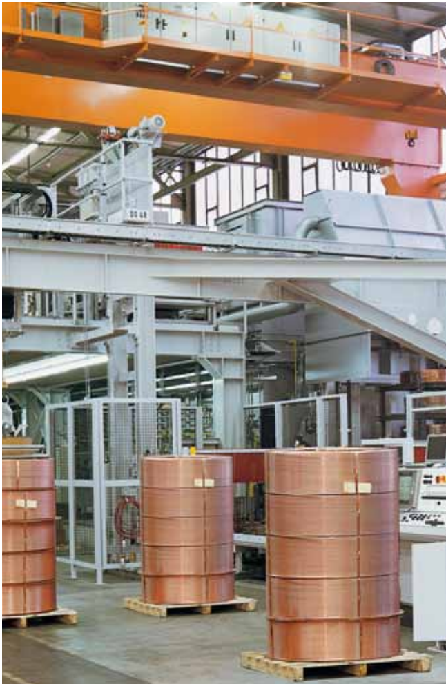
Lagengespulte Kupferrohre vor dem Ofen
